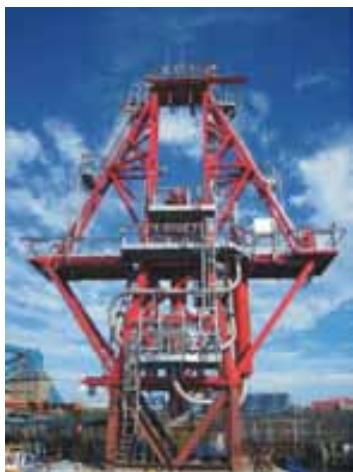
鑽油平衡補償機
