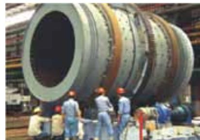
彰濱工業區旋窯式焚化爐窯殼
