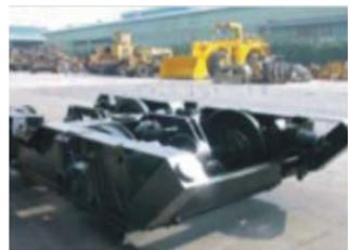
台北捷運工程車轉向架
