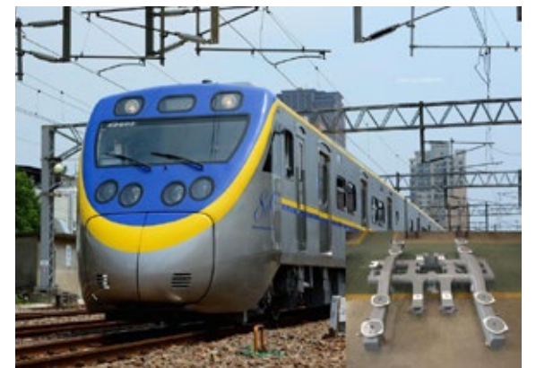
台鐵普悠瑪號與 EMU800 型電車轉向架
