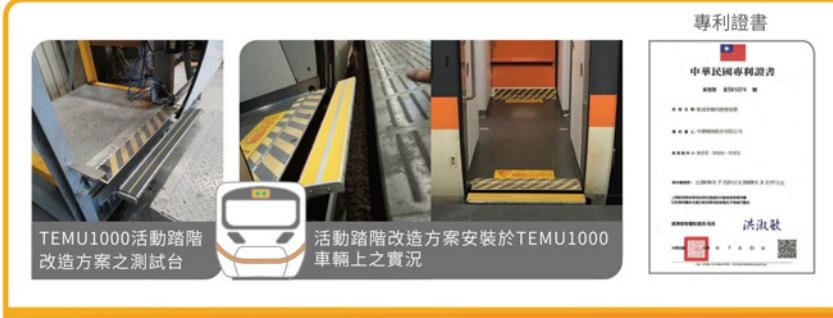
另鐵路改建工程局將逐步將既有92公分高的月台，改造提升至115公分與車廂高度平行，而太魯閣號(TEMU1000)64輛車廂，則需待臺鐵完成月台改造後，中機才能施工為滿足該傾斜式車廂達無階化，所客製設計製作的活動踏階機構(中機新型專利M581074號)。
