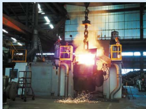
▶ 汗水與鐵水的搏鬥——週波爐生產作業。
